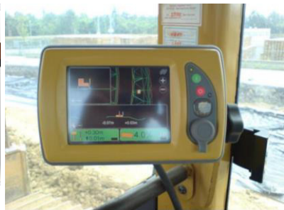
Bild 19 Mengenermittlung und Detail Maschinensteuerung auf Grundlage des BIM-Modells [Bauer Bauunternehmen, BIM-Praktikertag2018, DigiWertBau ]
