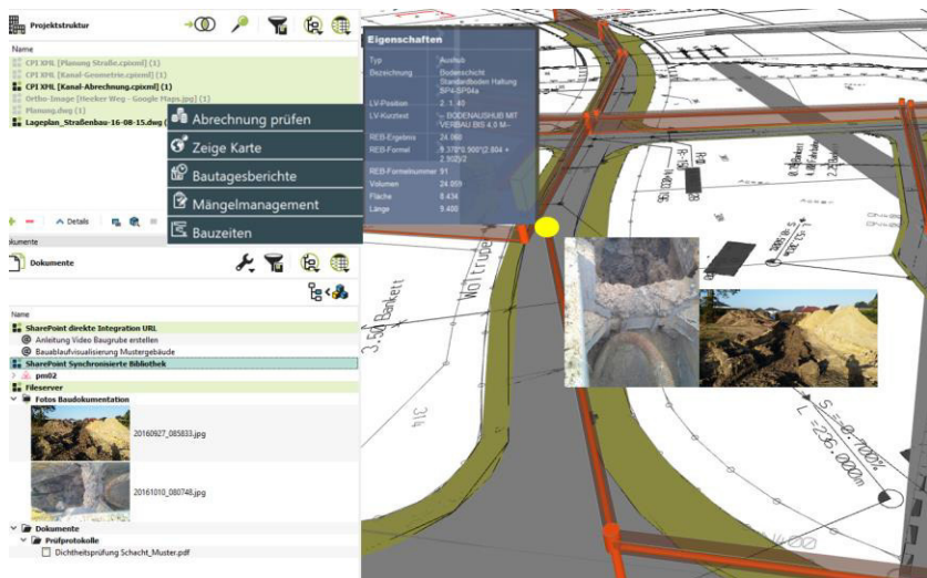
Bild 20 Modellbasierte Baustellendokumentation und Verwaltung von Abrechnungsmodellen, angereichert mit zusätzlichen Informationen (Bilder, Lieferscheine, Bautagebücher, Pläne, usw.) [Multiprojektraum von BRZ-Desite MD , BRZ Deutschland GmbH]
